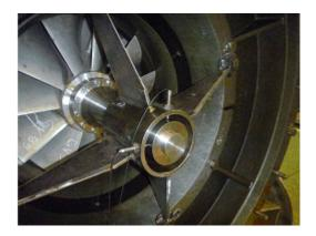
FIGURE 2. DUMMY ROTOR VIBRATION MEASUREMENT TEST
